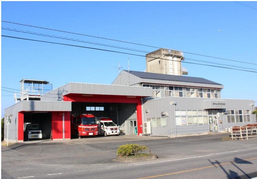
北分署は昭和63年度に建築され、築後35年が経過した建物です。大規模改修の目安である30年を超えたことから、令和3年度に屋根・外壁塗装、防水工事を実施しました。予防保全を徹底し、建物の長寿命化を図ります。
